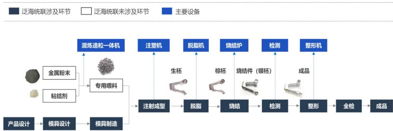
图35：公司 MIM 工艺流程
