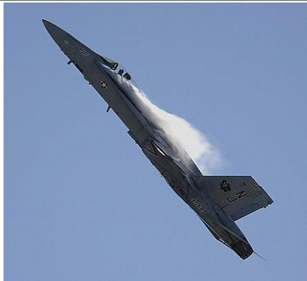
图表 37：F/A-18C 的高迎角导致在前缘延伸处形成强大涡流
