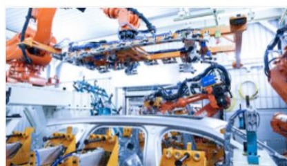
白车身顶盖激光焊接系统
