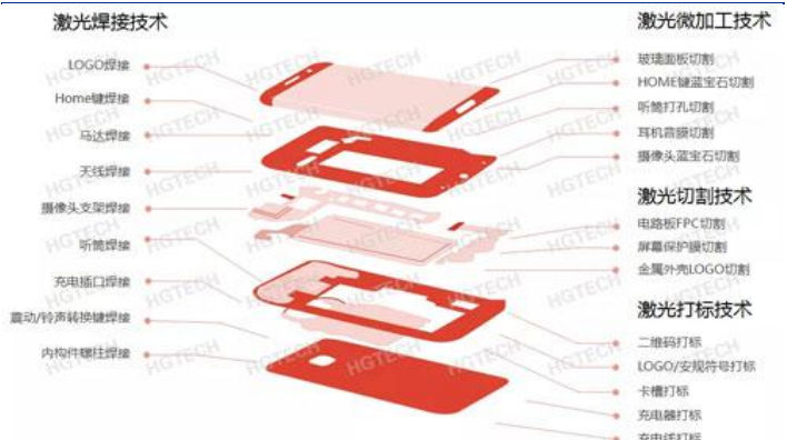
图 26：精密激光加工在手机制造中的应用
