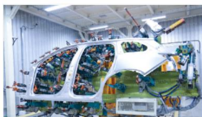
白车身侧围及车门激光焊接系统
