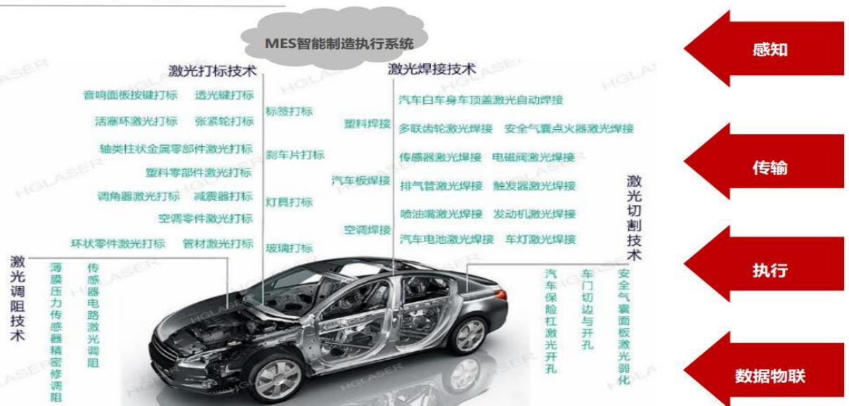
图 24：华工科技激光加工技术在汽车制造当中的应用
