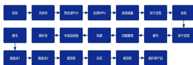
图 13：贴面超纤制作流程
