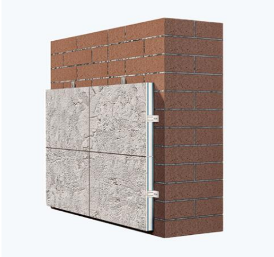
图16: 建筑用真空绝热装饰一体化板示意图
