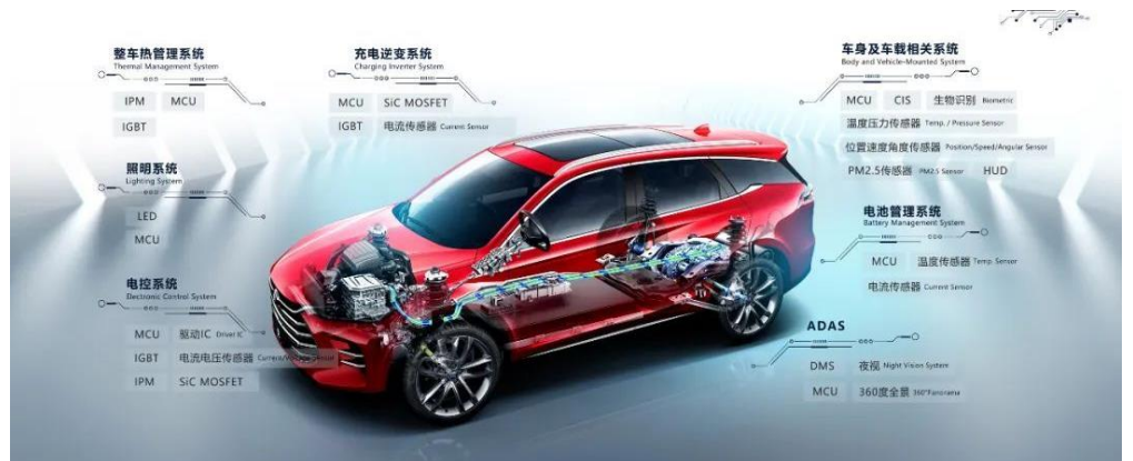
图 38：功率半导体在新能源汽车中的应用广泛
