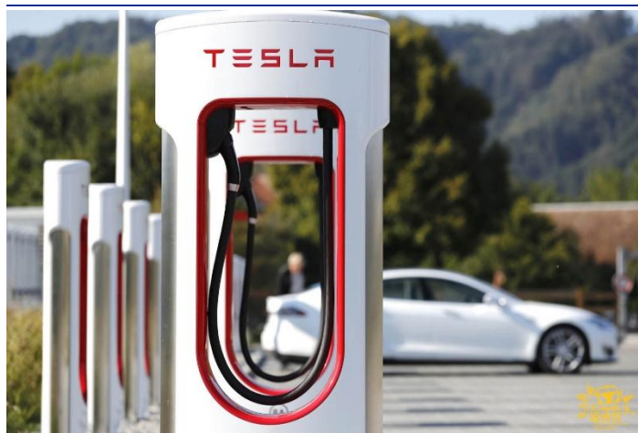
图 36: V3 超充电桩与 V2 外观差异不大,但是功率达到 250kW
