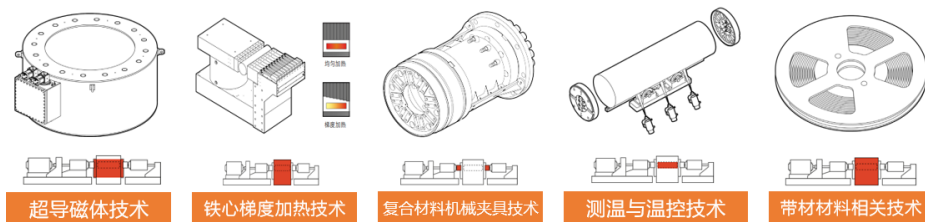
图 23：超导感应加热设备在制造过程中需要突破一系列关键技术点
