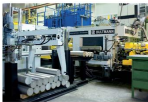
Zenergy Power GmbH公司2008年提供给Weserlau挤压厂的设备
