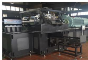
韩国Supercoil公司2017年研发的300kW超导感应加热设备
