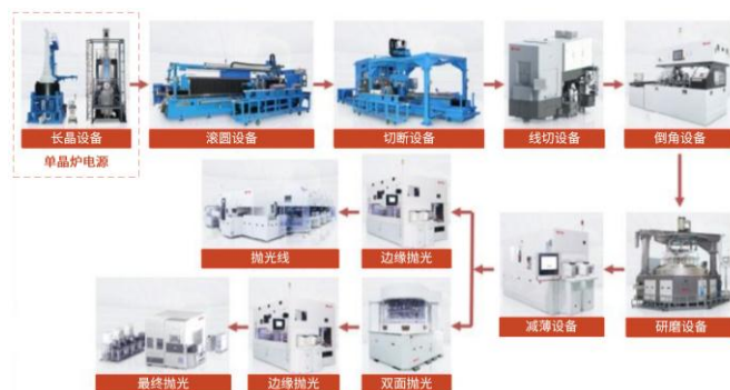
图 17：单晶炉电源在硅片制备过程中的应用
