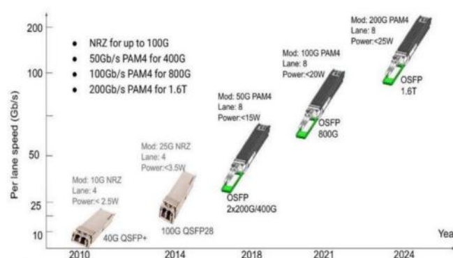
图表101：谷歌在数据中心内部所使用光模块速率的升级历程
