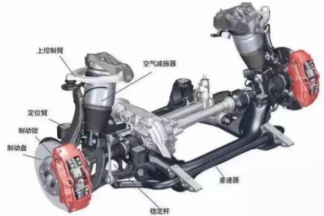
图74：空气悬架是以空气弹簧为弹性元件的悬架系统，它的最大特点是变刚度与易于调整
