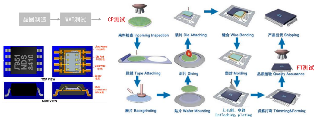
图 5：封测生产流程
