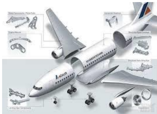
图 32：典型飞机结构分段
