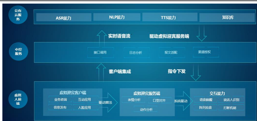
图26：萤石网络数字人技术架构
