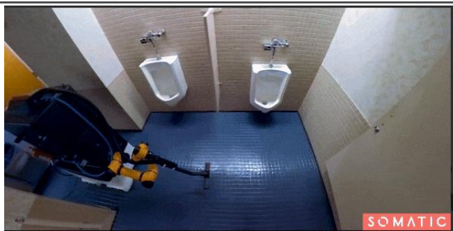
图48: Somatic 清洁机器人通过机械臂清洁厕所
