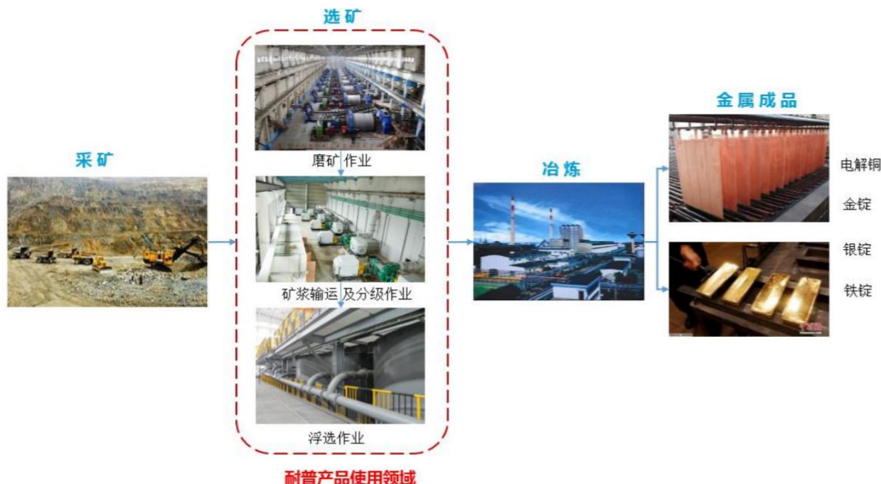
图表 10: 公司产品所处设计选矿流程图
