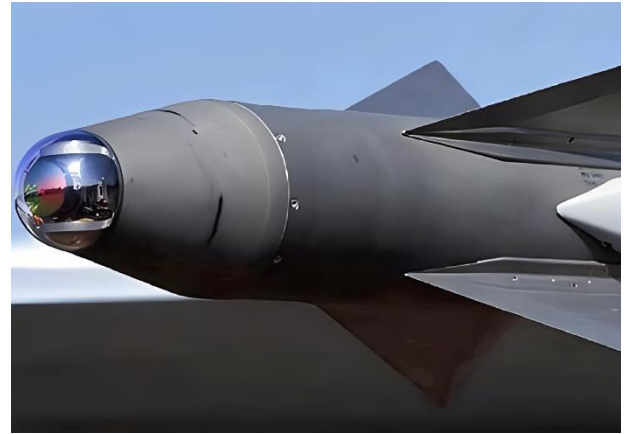
图37: 响尾蛇导弹透红外陶瓷整流罩
