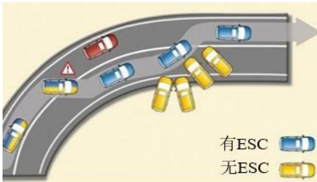
图 21: ESC 系统工作效果图
