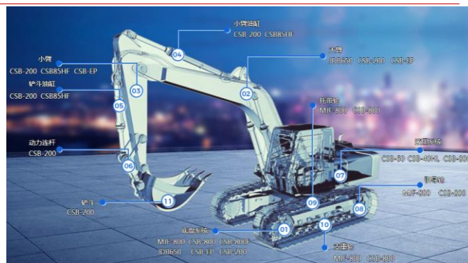
图表 26：自润滑轴承在挖掘机上的应用
