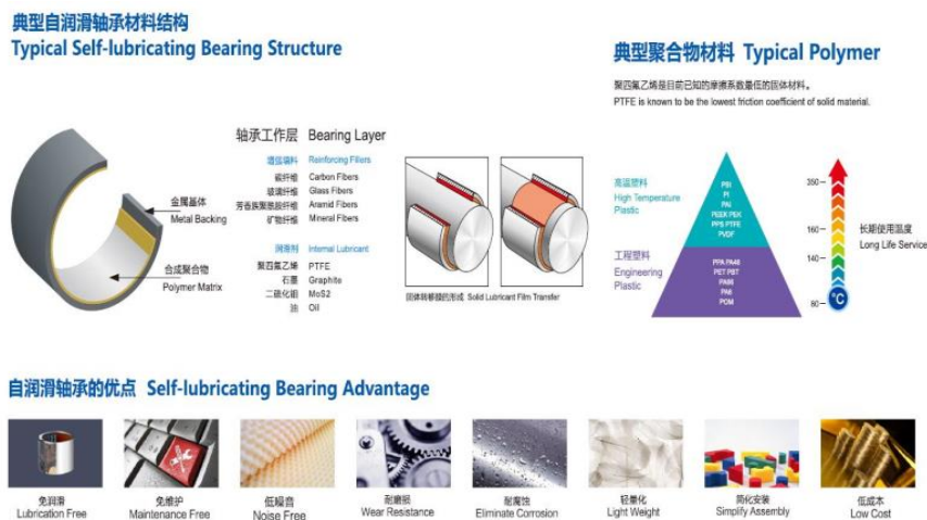
图表 17：自润滑轴承的结构及优点
