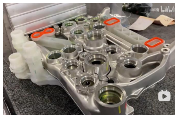
图28: Model Y 热泵中冷媒侧和水路侧的组件高度集成
