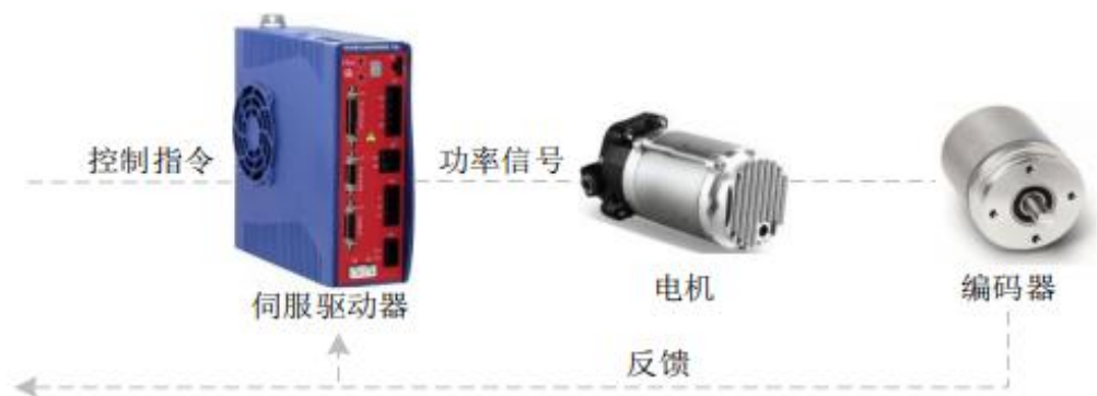
图 7：伺服系统基本结构
