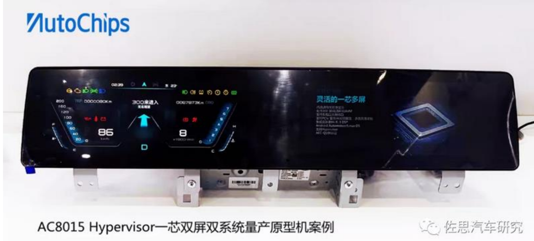
图 4 AC8015 Hypervisor 一芯双屏双系统量产原型机案例
