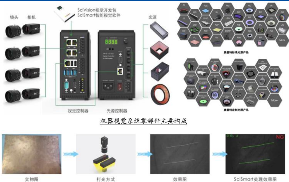
通过机器视觉系统实现金属板划痕检测的场景举例
