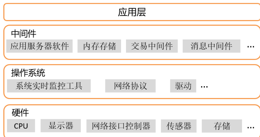
图 5：中间件位于操作系统之上，应用层之下
