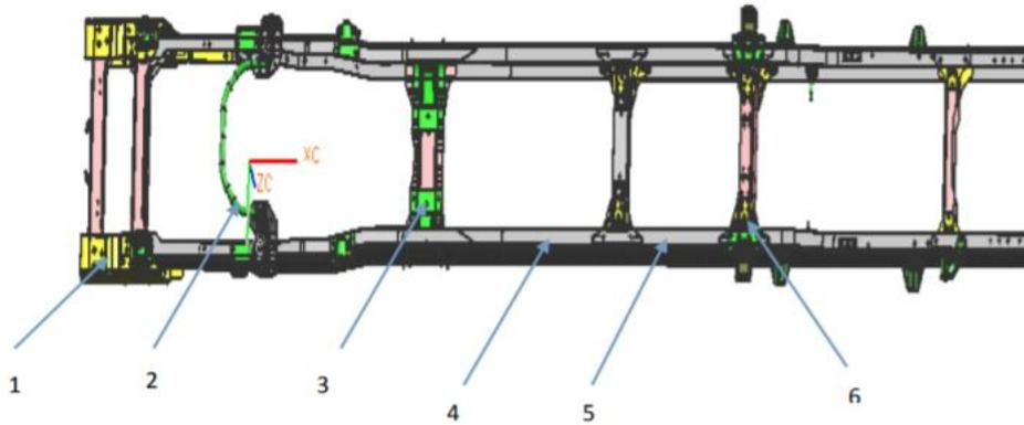
1、第一横梁总成；2、发动机支撑梁总成；3、第三横梁总成；4、纵梁；5、纵梁加固板总成；6、第五横梁总成。
