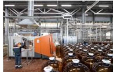
PBT瓶智能生产线: 17600BPH/1500ml
