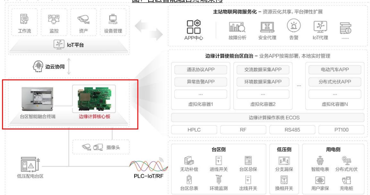
图：台区智能融合终端架构
