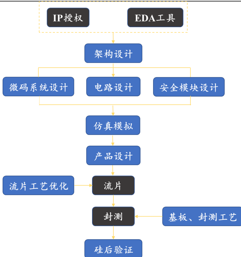
图表 3：海光高端处理器产品设计、生产流程
