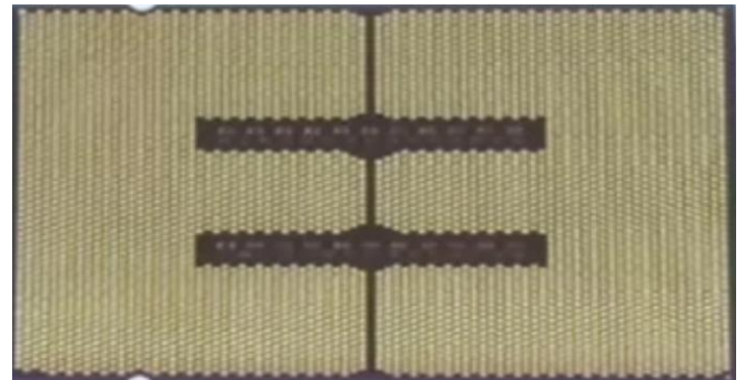
图 12: 3D5000 芯片由 2 颗 3C5000 芯片封装而成
