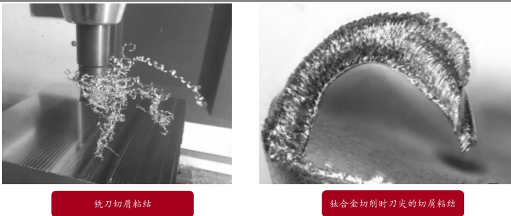
图表 39. 钛合金在 CNC 加工时易发生切屑粘结
