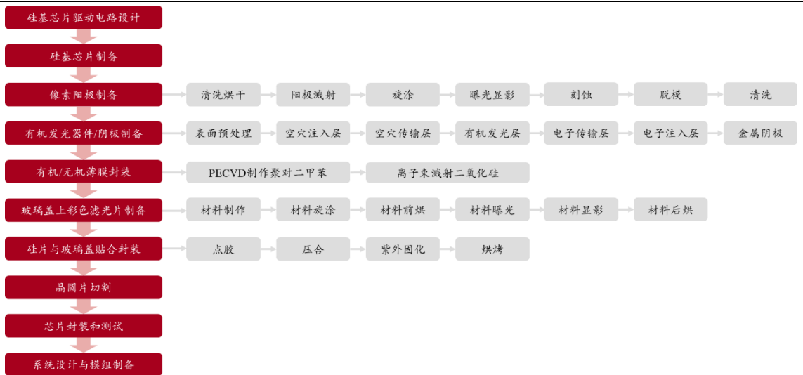
图表 52. 硅基 OLED 的工艺流程
