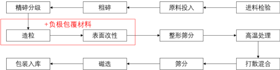
图：人造石墨产品制备流程路线一
