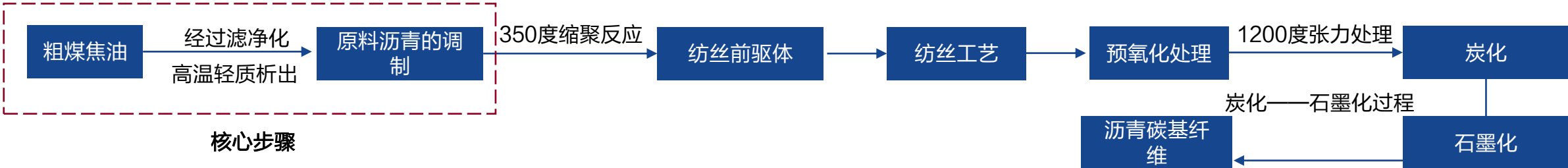
图：煤沥青基碳纤维制备工艺
