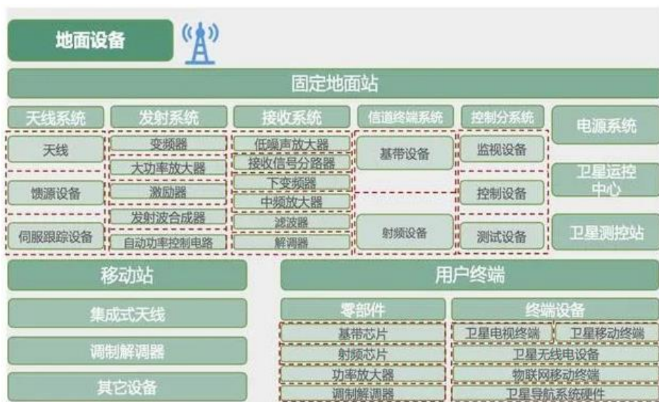
图14：地面设备细分环节包括固定地面站、移动式地面站和用户终端三部分
