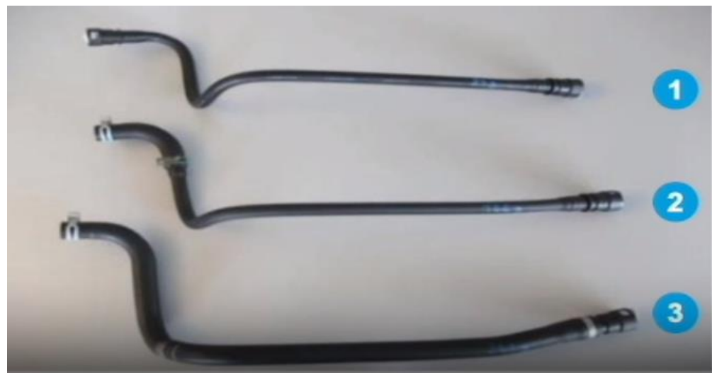
图10：尼龙材质冷却水管重量较胶管可减重约 50-60%
