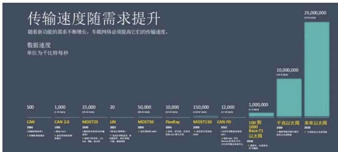
图34: 智能化的发展，车载网络需要提高传输速度
