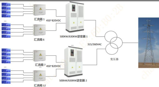
图表 22. 集中式逆变器先汇流再逆变
