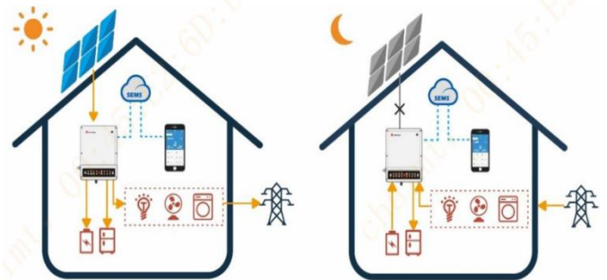
图表 43. 储能逆变器工作原理
